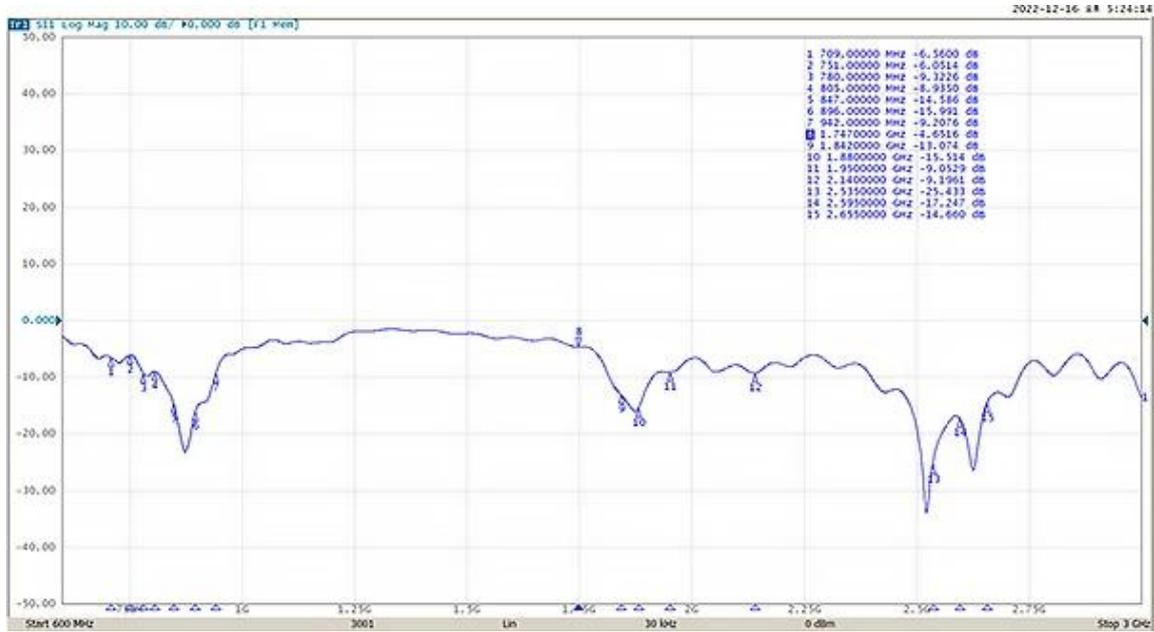
**VSWR** (antenne mesurée avec un câble d'extension de 1.0M dans un espace libre)
