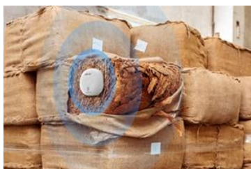
Contrôle de T° de pile à tabac
